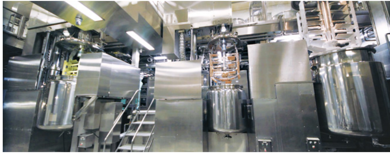
▲製造量に合わせた様々なサイズの真空乳化機
